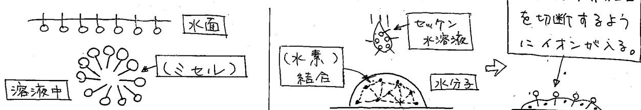
油でよごれた繊維をセミテン水溶液に沈すと、この作用で、繊維は水溶液で浸透しやすくなる。
